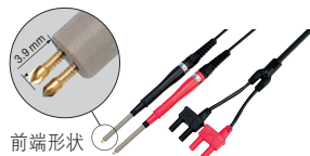
针型测试线L2110 A: 750mm, B: 215mm, L: 1880mm, DC1000V
