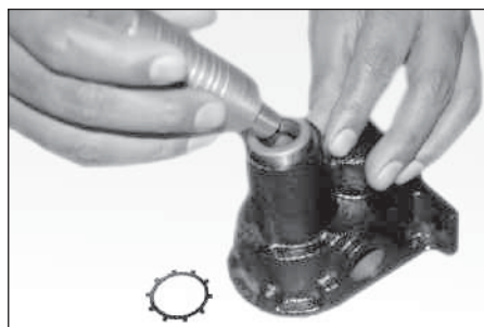
Fig.12 REPUESTO- LIP de obturación
