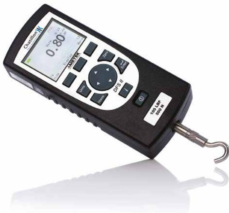
在现有数字测力计中，Chatillon® DFS II 系列具有最高性能价格比。这一系列的测力计小巧、易用，可用于基本及复杂测量。DFS II系列提供理想的手持式或支架式应用，可以配备用于载荷测量或扭矩测量的一体式测压元件或智能远距传感器。一体式测压元件或专用远距型号的测量精度由于全量程的0.1%。高分辨率、全色、点阵式大液晶屏易于读取，可支持各类标准计量功能，包括正常和峰值读数。载荷显示单位为：ozf, gf, lbf, kgf 和 N。显示器可以转化，显示结果可以“隐藏”。DFS II 提供测力计设置密码保护。
